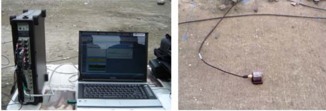
Şekil-3. Deneysel ölçümlerde kullanılan veri toplama ünitesi ve üç eksenli ivmeölçer.
