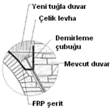
Şekil-5. Tonoza yapıştırılmış FRP şerit ile mevcut duvar arasındaki detay, Kaynak: Bastianini ve diğerleri, 2005.
